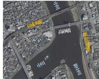
ここで紹介されている橋は8基のコンクリートの橋脚を持つプレートガータ型鋼鉄桁橋であったが、平成15年（2003）に現在のシンブルな2径間連続斜張橋（塔から斜めに張ったケーブルを橋桁に直接つなぎ支える構造の橋）に架け替えられた。
